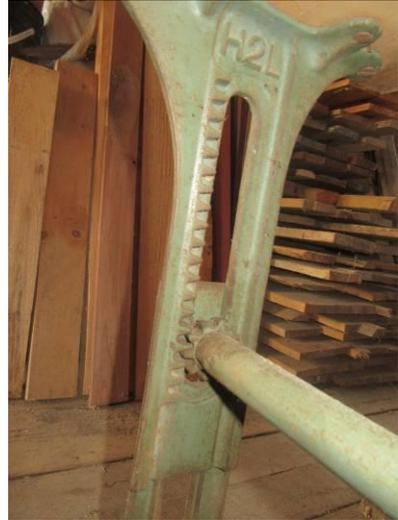
Bureau de l'école de Mawcook avec la rainure pour les crayons, l'orifice pour l'encrier. Le pied métallique repose sur un «patin» de bois pour déplacer le meuble. Photo de droite : mécanisme pour ajuster la hauteur.
